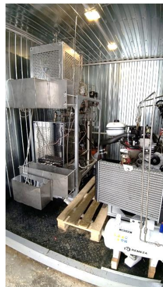
Экспериментальный образец установки утилизации дымовых газов
