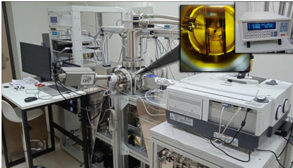
Внешний вид криогенной сверхвысоковакуумной установки для измерения ИК-спектров аналогов межзвездных льдов
