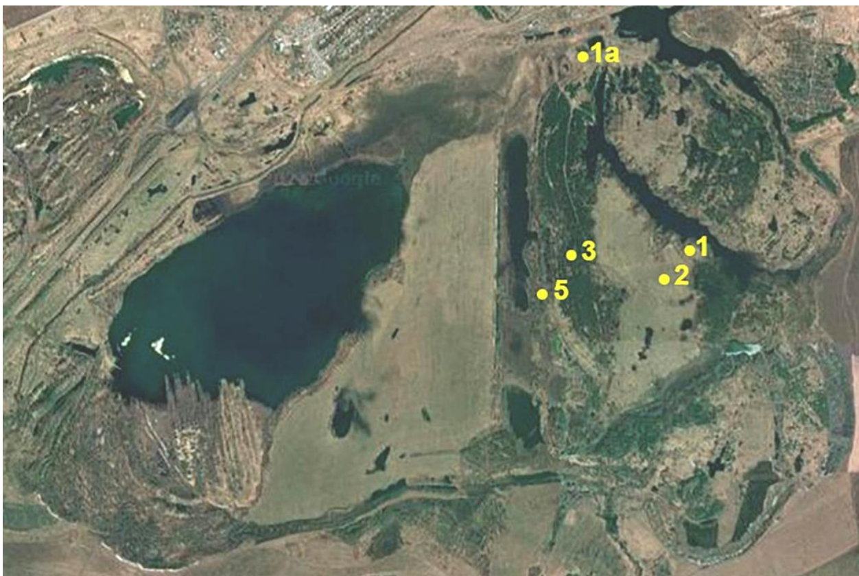
Рисунок – Центральный участок Назаровского разреза: точка 1 – Естественное зарастание на вскрышных породах; точка 1а – Естественное зарастание на вскрышных породах; точка 2 – Участок с отсыпкой ПСП; точка 3 – Посадки сосны; точка 5 – Переувлажненный участок
