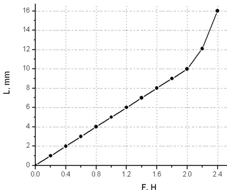
Определите по графику жесткость пружины динамометра и максимальное усилие при котором прибор будет корректно работать.
